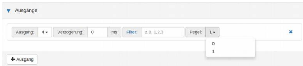
Abbildung 11: Konfiguration "Level" Ausgang
